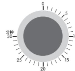
0-30分钟定时旋钮，时间最多可以设定为30分钟。当设定到“0”档，电烤炉将处于断电状态。
