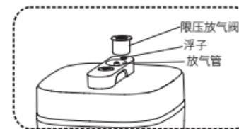
放置好限压放气阀，检查浮子是否落下，未加热之前浮子是落下的。
