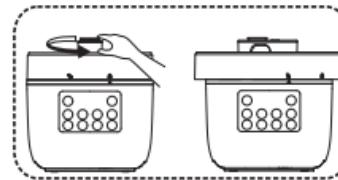
开盖：确保浮子落下，用单手紧握上盖把手，逆时针旋转上盖至开盖到位标识 对准机身箭头 ，然后向上提起上盖；
