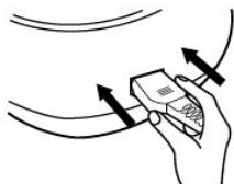
! 插头插到插座时，必须插到底，否则会因接触不良而导致元件过热烧坏，引发短路或火灾等危险。
