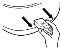
! 拔下插头时,必须握住插头柄,不能拉扯电源线,否则易损伤电源线。
