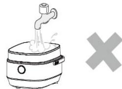
! 煲体禁止进水、用水冲洗和浸泡,以免发生触电或短路。
