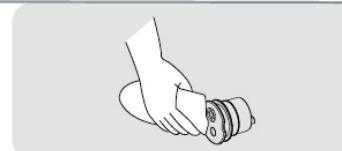
**3** 手握蒸汽阀，指示箭头向下，将蒸汽阀往里摁到底，安装完毕。
