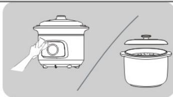
**2** 将提手环放置于机器上面，再将装好食材的内胆居中放入机器内。
