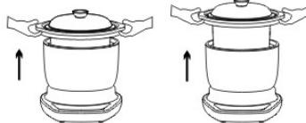
**4** 将炖盅放置于平整的桌面，旋转防烫提手环使一侧炖盅把手处于旋出口位置，倾斜旋转取出防烫提手环。
