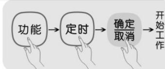
**2** 在整机工作状态或保温状态下，按下**〔确定/取消〕**键，可取消当前工作状态。
