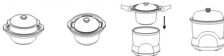
2. 烹饪后，可直接端起外环两侧把手将炖盅一同取出（取出时小心蒸汽扑出烫手），再将炖盅放置于平整桌面，将外环旋转取出。
