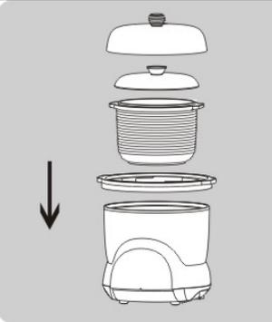
**3** 使用不锈钢内胆做蛋羹、加热辅食时：向整机内加适量水，将装好食材的不锈钢内胆居中放入机器内。
