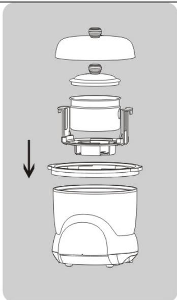
**4** 使用奶瓶热奶时：建议配合蒸架使用。
