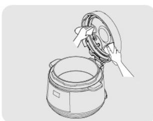
**5** 清洗保养完毕后请再次确认防堵件、密封圈、限压放气阀等已正确安装。
