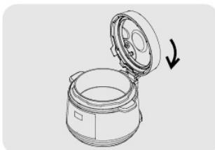
**4** 用水清洗上盖内侧，包括密封圈、限压放气阀、放气管、浮子等，然后用干净的湿布擦干净。
