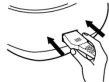
⚠ 使用前，必须确保电源线与主机连接可靠，否则会因接触不良导致器件损坏。
