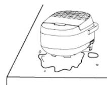
⚠ 请不要将本产品放在不平稳、潮湿、高温、光滑、不耐热(如塑料台布、棉布、地毯等)的台面上，以免触电、起火、脱落等造成伤害事故和财产损失。
