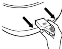
⚠ 拔下插头时，必须握住插头柄，不能拉扯电源线，否则易损伤电源线。
