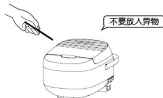
⊘ 禁止在产品内部或缝隙中插入金属屑、铁丝、针等异物，否则会引起触电或工作异常。
