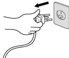
⚠ 不使用时，请拔下电源线插头，以防短路、器件老化引发自燃等。
