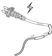
⚠ 电源线或插头破损，插座松动时，请不要使用，以免造成触电、着火。
