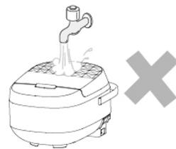
⚠ 煲体禁止进水、用水冲洗和浸泡，以免发生触电或短路。
