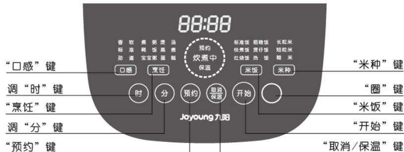
注：“圈”键在关机状态下，启动操作待机
