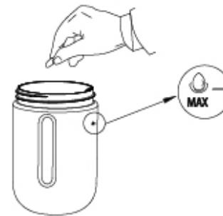
3. 倒置主机顺时针旋紧到杯体上，确保杯体指示圆点对齐主机圆点。
