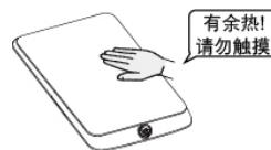
（○）严禁将机器放在燃气灶、电炉、金属台面等物体上面工作，因磁力线会将铁质金属器件加热，造成烫伤、火灾等事故。
