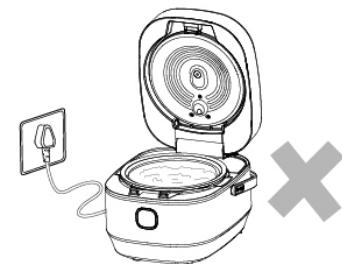
! 工作过程中停电时，请拔下插头，来电后重新操作。
