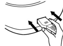
! 插头插到插座时，必须插到底，否则会因接触不良而导致元件过热烧坏，引发短路或火灾等危险。
