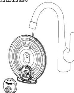
b 用清水将可拆内盖、密封圈清洗干净，并用软抹布擦干，扣合后安装好。
