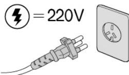
! 工作电源使用220V~50Hz交流电，不得使用其他电源，否则会损坏元器件或引起火灾、触电等事故。
