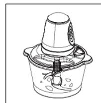
4. 将主体上凸起部分对准绞肉杯盖上的凹陷部分，放置在绞肉杯盖上。
