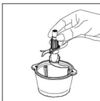
2. 将绞肉刀组合放入绞肉杯内，将食材放入绞肉杯中。
