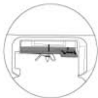
冲浆压板锁紧位置
