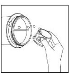
2. 将搅拌刀座与调理杯旋紧；顺时针将卡口拧紧在主体上。
