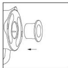
4. 将量杯塞入杯盖上的加料口中，塞紧为止（如果之前没有从杯盖上拿下则无此动作）。
