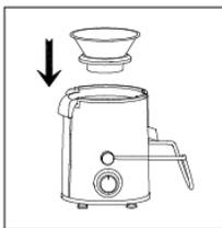
2. 将刀网放入集汁盘中，确保刀网在连接头上安装到位。
