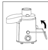
4. 向上拉搭扣（如左图箭头方向所示），将搭扣拉到上盖卡槽内，如左下图所示，确保搭扣安装到位，否则产品不能正常工作。
