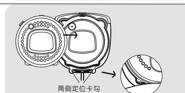
**4** 按动开关，将蒸汽阀上下盖分离开来，用清水将蒸汽阀清洗干净，并用软布擦干，将蒸汽阀上下盖安装好并扣合，之后安装到煲体盖上。
