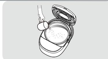
**3** 合上上盖，按【功能】键，选择热饭功能，热饭指示灯常亮，开始指示灯闪亮，按下【开始】键，电饭煲显示屏显示动态旋转线框，电饭煲开始工作。
