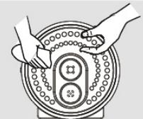
**3** 将可拆内盖下部两侧定位卡勾插入煲盖下部的定位槽中，再将可拆内盖往里摁进去，听到“咔”声后，安装完毕。
