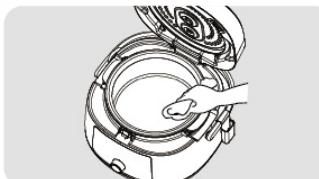
**6** 取出内胆，用柔软的海绵清洗干净，然后用干软布擦干。取/放内胆时请轻拿轻放，避免碰撞变形；切勿使用钢丝球或者硬物擦洗内胆。
