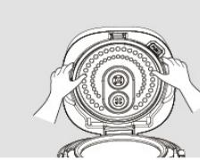
**4** 煲盖上的蒸汽阀可以直接用手抠出，将蒸汽阀清洗干净并用软布擦干，然后安装到煲盖上。
