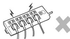
(!) 插头插到插座时，必须插到底，否则会因接触不良而导致元件过热烧坏，引发短路或火灾等危险。
