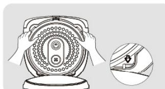
**4** 煲盖上的蒸汽阀可以直接用手抠出,将蒸汽阀清洗干净并用软布擦干,然后安装到煲盖上。
