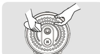
**3** 将可拆内盖下部两侧定位卡勾插入煲盖下部的定位槽中,再将可拆内盖往里摁进去,听到“咔”声后,安装完毕。
