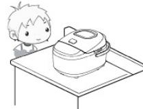
禁止在产品内部或缝隙中插入金属屑、铁丝、针等异物，否则会引起触电或工作异常。
