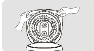
**2** 用清水将可拆内盖、密封圈洗干净,并用软抹布擦干。
