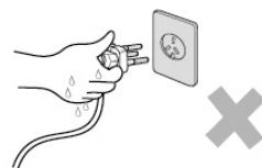
(!) 拔下插头时，必须握住插头柄，不能拉扯电源线，否则易损伤电源线。
