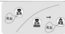
**2** 锅内温度偏低时，电饭锅加热，加热指示灯亮起；加热到一定温度后，加热指示灯熄灭，保温指示灯亮起；
