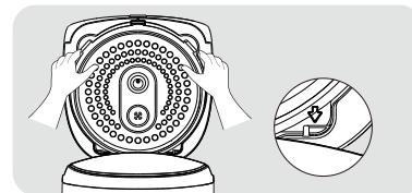
**4** 一只手握住蒸汽阀帽，另一只手按开盖方向推后推蒸汽阀，将蒸汽阀上下盖分离开来，用清水（可用少量餐具清洁剂）将蒸汽阀清洗干净，并用软布擦干，将蒸汽阀上下盖安装好并摁压扣合，之后安装到煲体盖上。
