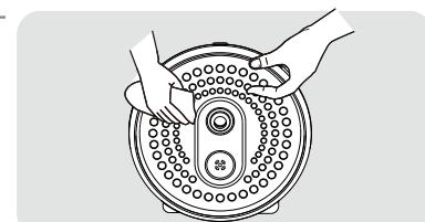
**3** 将可拆内盖下部两侧定位卡勾插入上盖下部的定位槽中，再将可拆内盖往里摁进去，听到“咔”声后，安装完毕。
