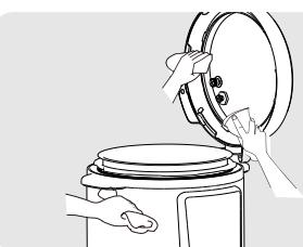
**5** 清洗保养完毕后请再次确认防堵件、密封圈、限压放气阀等已正确安装。
