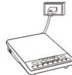
3 4 使用时应远离燃气灶等高温发热器具，当环境温度过高时，可能导致电磁灶过热保护，暂时停止加热。
