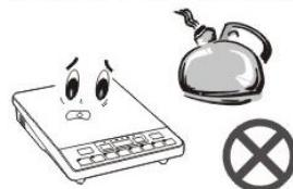
5 严禁将机器放在燃气灶、电炉、金属台面等物品上面工作，以免发生危险。
