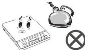
严禁将机器放在燃气灶、电炉、金属台面等物品上面工作，以免发生危险。
