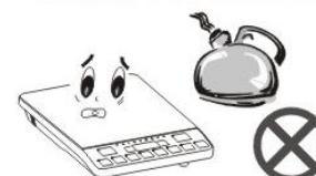
5 6 严禁将机器放在燃气灶、电炉、金属台面等物品上面工作，以免发生危险。
