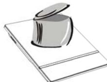
8 请勿将纸张、布等易燃物品垫在陶瓷板与锅具之间，或机器底部加热，以免工作时引起燃烧发生危险。
