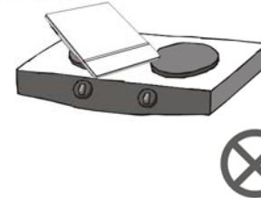
7 8 罐头类等密封食品，请将盖子打开后再加热，避免受热膨胀而产生爆炸危险。
