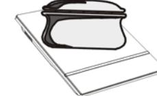
7 8 请勿将纸张、布等易燃物品垫在陶瓷板与锅具之间，或机器底部加热，以免工作时引起燃烧发生危险。
