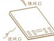
严禁将铁丝、螺丝等插入进、排风口,以免发生触电等危险。
