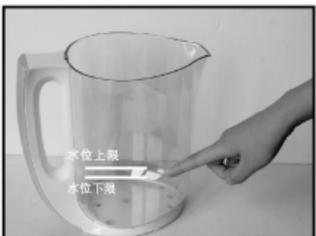
请将水加至上、下水位线之间。（本机具有无水防干烧功能，如杯体内无水或水位过低，机器不会工作，以保证使用安全。您若想缩短制浆时间，可以加入70度以下的温水制作米糊）。
