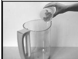
用干豆量杯按照2/3刻度量取大米。连同浸泡好的黄豆一起洗净后放入杯体内。
