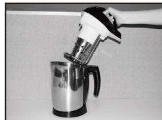
取五谷精磨器按照安装指示箭方向装好，五谷精磨器口部与下盖配合处应紧密无缝隙，安装完毕后，用手向下拉一下，五谷精磨器不动，说明安装到位。
