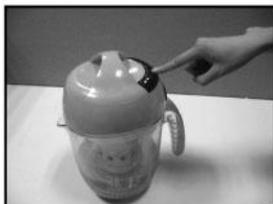
将机头按正确的位置放入杯体中，插上电源线，电源指示灯亮，按“选择”键，选取“五谷豆浆”，相应指示灯亮，按“启动”键，启动五谷豆浆程序。
