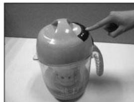
将机头按正确的位置放入杯体中，插上电源线，电源指示灯亮，按“选择”键，选取“玉米汁”相应指示灯亮，按“启动”键，启动玉米汁程序。
