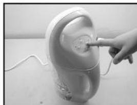
将机头按正确位置放入杯体中，插上电源线，电源指示灯亮，按下“绿豆豆浆”键，启动绿豆豆浆程序。
