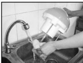
3、电热器：请用清洁块清洗电热器，将电热器粘的豆浆膜清洗干净，以免下次使用产生糊味。
