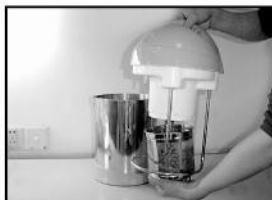
卸下网罩，将泡好的豆子加入网罩至网罩“加豆线”附近，但不宜超过“加豆线”，然后按安装指示箭头方向装好网罩，网罩口部与机头配合处应紧密无缝隙，安装完毕后，用手向下拉一下，网罩不动，说明安装到位。
