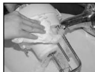
1、机头：请用水轻轻冲去机头下部粘附的豆浆或其他东西，切勿将机头浸入水中，也不要用水清洗机头上部，以防止机头进水，发生短路现象。
