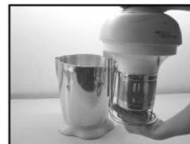
将泡好的豆子加入网罩，然后按安装指示箭头方向装好网罩，网罩口部与机头配合处紧密无缝隙，安装完毕后，用手向下轻拉一下，网罩不动，说明安装到位。
