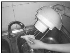
3、电热器：请用清洁块清洗电热器，将电热器粘的豆浆膜或其它东西洗干净，以免下次使用产生糊味。
