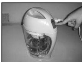
将机头按正确位置放入杯体中，插上电源线，电源指示灯亮，按下“全豆豆浆”键，启动全豆豆浆程序，具体制作全豆豆浆工作程序如下：
