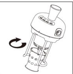
取五谷精磨器按照安装指示箭头方向装好，五谷精磨器口部与下盖配合处应紧密无缝隙，安装完毕后，用手向下拉一下，五谷精磨器不动，说明安装到位。
