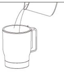
请将水加至上、下水位线之间。（本机具有无水防干烧功能，如杯体内无水或水位过低，机器不会工作，以保证使用安全。）
