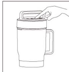
请将机头按正确的位置放入杯体中，插上电源线，指示灯全亮，按相应功能键，这时被选择功能对应图形指示灯亮，同时启动相应功能程序。
