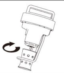
取五谷精磨器按照安装指示箭头方向装好，五谷精磨器口部与下盖配合处应紧密无缝隙，安装完毕后，用手向下拉一下，五谷精磨器不动，说明安装到位。
