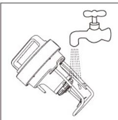
3. 电热器：请用清洁块清洗电热器，将电热器粘的豆浆膜或其它东西清洗干净，以免下次使用产生糊味。
