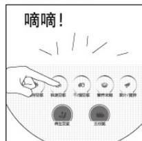
触摸相应的功能选择按键选择对应的功能，对应功能指示灯（或图形指示灯）亮并闪烁，并伴有“滴”一声提示音，3秒钟后机器自动启动，并伴有“滴滴”两声提示音提示已启动。
