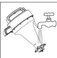
2 清洗超微精磨器：请用清洁刷仔细清洗超微精磨器，注意一定要用清水冲洗干净，以免残留饮品残渣产生异味。
