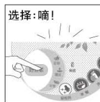
选择并按相应功能键，对应的功能图形指示灯常亮，机器自动启动该制作程序。
