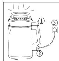
请将机头按正确的位置①放入杯体中，②插上电源线，③接通电源。
