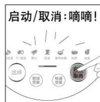
温馨提示 ①“倍浓豆浆”、“快速豆浆”为独立按键，触摸该键后，再触摸“启动/取消”键或等待3秒钟，机器开始工作。“快速豆浆”程序仅限干豆、湿豆豆浆的制作，用时15分钟左右（海拔500米左右、中水位、水温23℃左右、额定电压220V~）。
