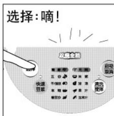
触摸相应功能键选择相应功能程序，每次选择机器都伴有“嘀”一声提示音，对应功能指示灯（或图形指示灯）亮并闪烁，触摸“启动/取消”键启动制作程序，机器伴有“嘀嘀”两声提示音，提示程序已启动。
