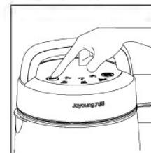
请将机头按正确的位置放入杯体中，插上电源线，指示灯全亮，按“选择”键，选择相应功能程序，当选择的功能对应图形指示灯亮时，按“启动/取消”键，启动相应的豆浆制作程序。
