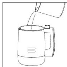
请按食谱中相应比例加配料，并加纯净水至上、下水位刻度线之间。（本机具有无水防干烧功能，如杯体内无水或水位过低，机器不会工作，以保证使用安全。）
