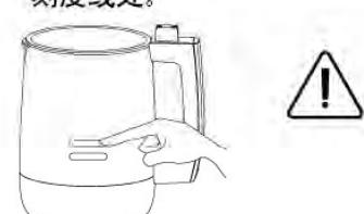
1. 机头、耦合器、底座、电源插座请勿进水，如果进水，必须擦拭晾干后才能使用。
