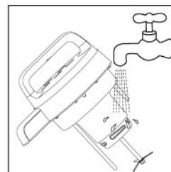
1. 机头：请用水轻轻洗去机头下部粘附的豆浆或其它东西，切勿将机头浸入水中，也不要用水清洗机头上部，以防止机头进水，发生短路现象。
