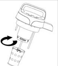
请将五谷精磨器按照安装指示箭头方向装好，五谷精磨器口部与下盖配合处应紧密无缝隙，安装完毕后，用手向下拉一下，五谷精磨器不动，说明安装到位。
