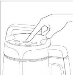
请将机头按正确的位置放入杯体中，插上电源线，指示灯全亮，按下相应功能按键，当选择的功能对应图形指示灯亮时，机器将自动启动相应的豆浆制作程序。
