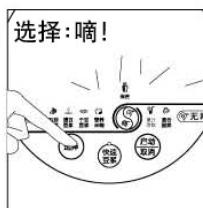
按“选择”键选择相应的功能程序，对应功能指示灯（或图形指示灯）亮并闪烁，按“启动/取消”键启动制作程序，机器伴有“嘀嘀”两声提示音，提示程序已启动。
