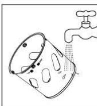
2 清洗五谷精磨器：请用清洁块仔细清洗五谷精磨器，注意一定要用清水冲洗干净，以免残留饮品残渣产生异味。
