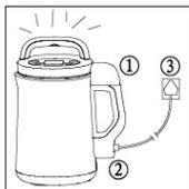
请将机头按正确的位置①放入杯中，②插上电源线，③接通电源。
