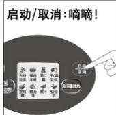
触摸相应的功能选择按键选择对应的功能，每次选择后，对应功能指示灯（或图形指示灯）亮并闪烁，并伴有“嘀”一声提示音，触摸“启动/取消”键启动功能，机器伴有“嘀嘀”提示音提示已启动。
