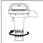
请将超微劲磨器按照安装指示箭头方向装好，超微劲磨器口部与下盖配合处应紧密无缝隙，安装完毕后，用手向下拉一下，超微劲磨器不动，说明安装到位。
