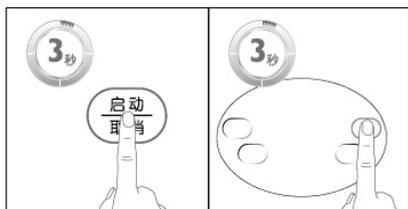
**3** 豆浆机发出三声“嘀、嘀、嘀”同时伴随着指示灯闪烁三次，即完成自适应功能（注意：如果没有以上现象，请拔下电源，重复以上操作）
