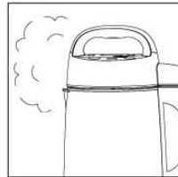
机器按设定程序运行到特定阶段，料斗内的物料自动落入杯体内，经过多次打浆自动粉碎、熬煮豆浆。
