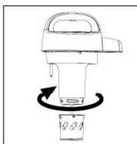
请将五谷精磨器按照安装指示箭头方向装好，五谷精磨器口部与下盖配合处应紧密无缝隙，安装完毕后，用手向下拉一下，五谷精磨器不动，说明安装到位。
