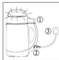
请将机头按正确的位罝①放入杯体中，②插上电源线，③接通电源。
