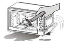
本烤箱使用高温钢化玻璃门，请不要刮伤玻璃或敲击玻璃的边缘，以免玻璃爆裂。
